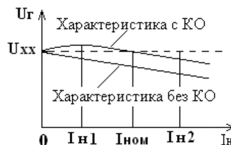
Рисунок 3.7 – Нагрузочные характеристики системы.
